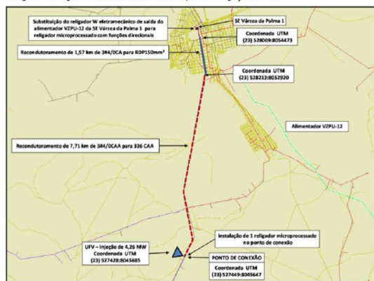
Figura 1 - Principais obras necessárias para interligação da GD.
